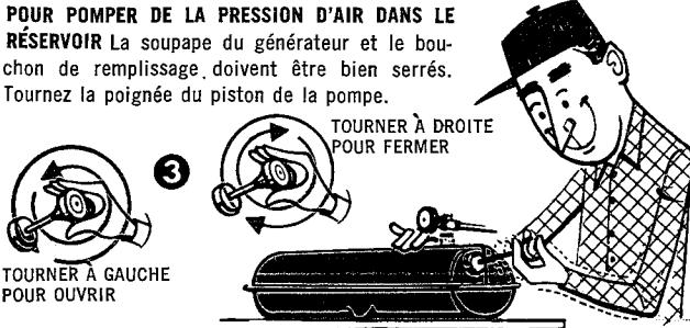
(3) de deux tours complets à gauche. Mettez le pouce sur le petit trou de la poignée et pompez à fond de 35 à 50 fois pour remplir le réservoir d'air. Puis, tournez la poignée du piston de la pompe à droite et serrez-la fermement.
