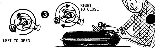
plets la poignée du plongeur de pompe (3). Placer le pouce en travers le petit trou dans la poignée et pomper 35 à 50 coups d'air dans le réservoir. Alors tourner à droite la poignée du plongeur de pompe et la serrer.
