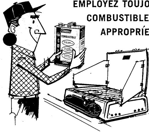
Utilisez seulement du combustible Coleman ou du naphte. N'utiliser jamais des combustibles contenant des compositions plombées ou d'huiles de graissage, parce que des matières dans l'essence qui ne vaporisent pas bloquent de carbone le générateur de votre poêle. C'est la sorte de combustible que vous utilisez qui détermine principalement la durée de votre poêle et de votre générateur.
